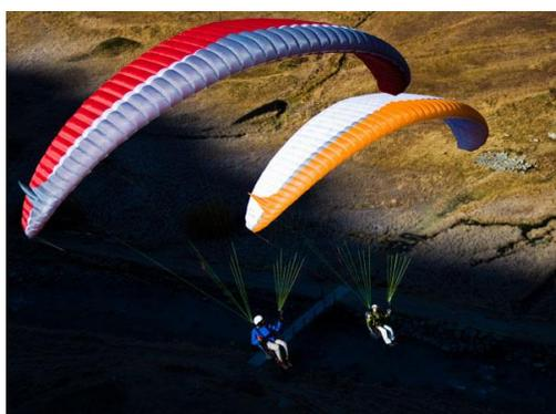
Je ne pouvais pas débiter sans évoquer **ADVANCE** et ses winglets, caractéristiques de la marque. Certes, le système commence à dater, mais il permet de canaliser les filets d'air sur les stabilos, de diminuer la traînée, donc de performer.
